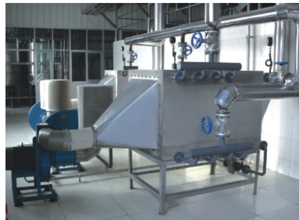
奶粉工程进风部分 Air intake system for milk powder
