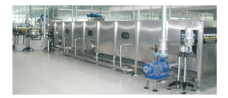
适用于灌装后马口铁罐,玻璃瓶,PET瓶等物料的杀菌及冷却。
